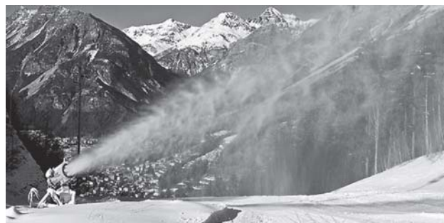
Rys. 6. Wytwornica sztucznego śniegu włoskiej firmy "Technoalpin" w działaniu
