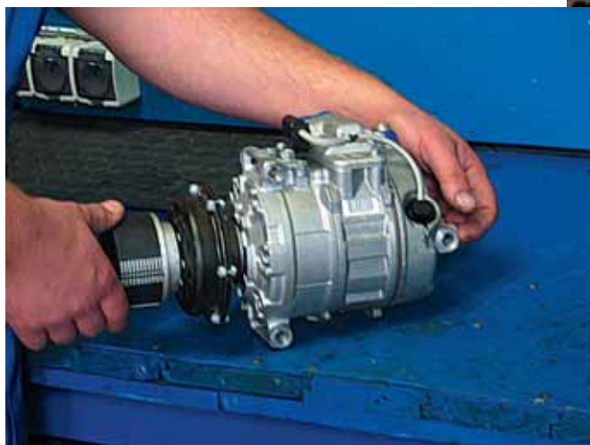
Fot.10 Agregat po przeglądzie przygotowany do montażu w instalacji
