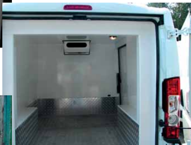
Fot.7 Wnętrze pojazdu izotermicznego wyposażonego w urządzenie chłodnicze
