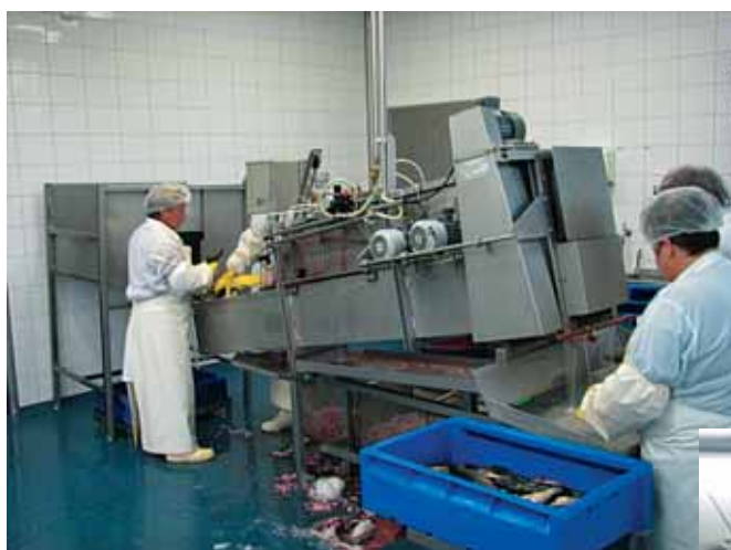
Fot.1 Linia technologiczna obróbki pstrąga w fazie jego przygotowania do składowania w komorze mroźni
