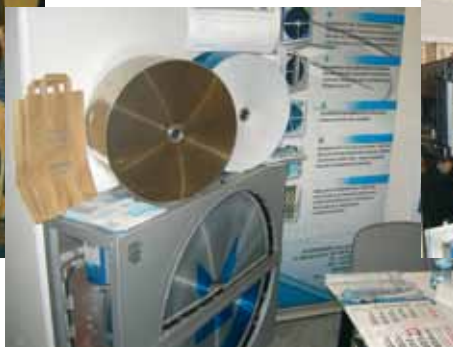
Fot. 11. Na stoisku firmy KLINGENBURG można było zapoznać się z budową regeneracyjnych obrotowych wymienników ciepła
