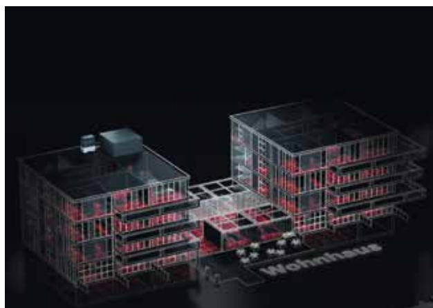
Rys. 6. System C - idealnie nadaje się do seryjnych projektów budowlanych. System o wysokim stopniu prefabrykacji redukuje prace projektowe nawet o 90% dzięki możliwości jego przeskalowania do innych projektów
