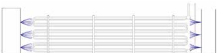
Rys. 5. Schemat celowanego „omywania” węzownicy przez dysze obiegu wody
