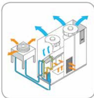
Rys. B: Chłodzenie mieszane
