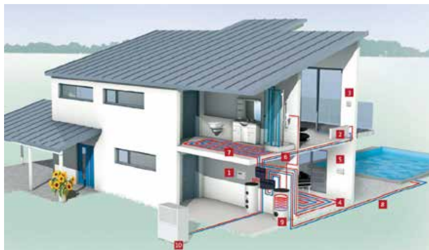
Rys. 1. Zintegrowany system do ogrzewania i chłodzenia na przykładzie rewersyjnych pomp ciepła powietrze/woda typu LA35-60TUR+ marki Dimplex ( www.dimplex.pl )
